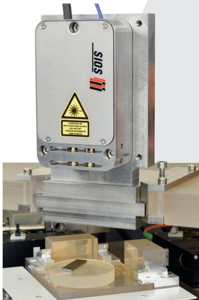
干涉儀的長度解析度為5 pm，藉由此測量系統的差動原理，即使在一般實驗室條件下亦能達成此解析度。
